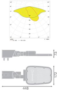
Scheda tecnica Ledvance Proiettore LED Area Grande Grigio 45W 5850lm 160x58D - 730 Luce Calda | IP66 - Simmetrico
