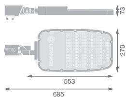
**Scheda tecnica Ledvance Illuminazione Stradale LED Area Extra Large RV35ST Aluminium Grigio 150W 20250lm 155X69D - 765 Luce Del Giorno | IP66 - Asimmetrico**
