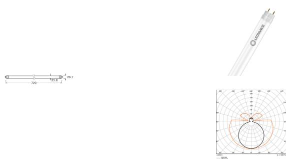
**Scheda tecnica Ledvance Tubo LED T8 EM Value Conventional (EM), Mains (AC) Standard Output 7W 850lm - 865 Luce Del Giorno | 72cm - Sostitutiva 16W**
